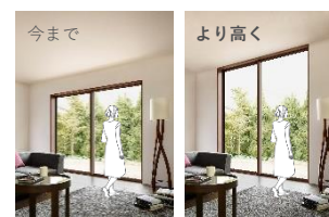
天井の高さ：2400mm 天井の高さ：2700mm 窓の高さ：2000mm 窓の高さ：2700mm
