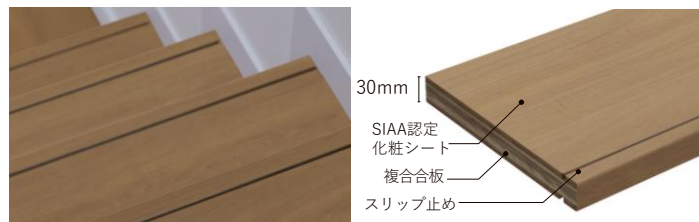
踏板断面 鼻の出：20mm
