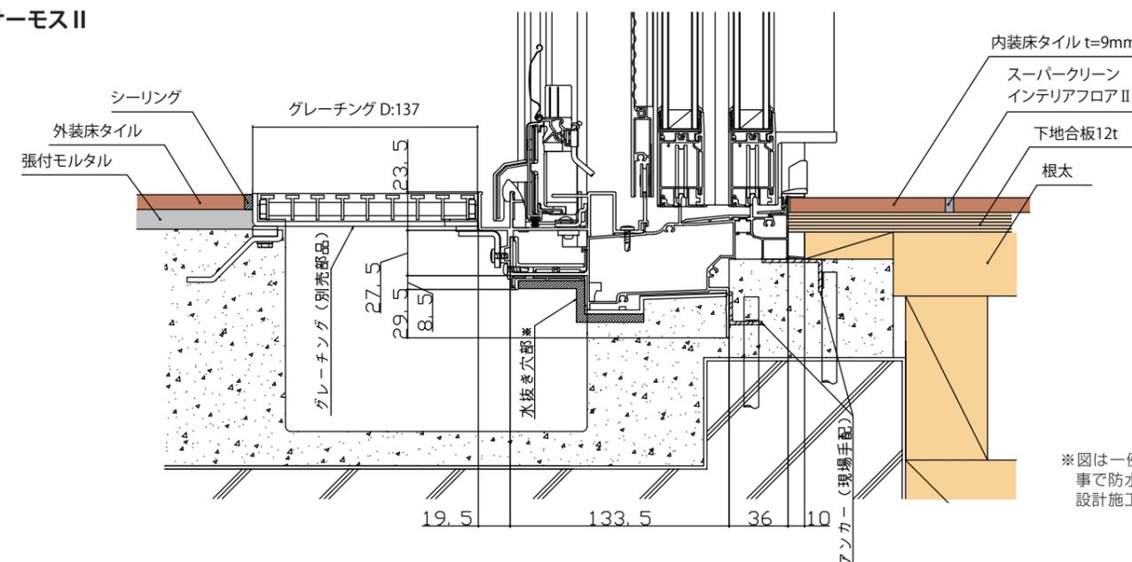
※図は一例です。雨が降り込む場所では、建築工事で防水対策を施してください。内装床タイル設計施工マニュアルもご参照ください。
