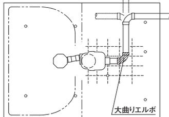
最初に曲げる90°継手には大曲りエルボを使用する。
