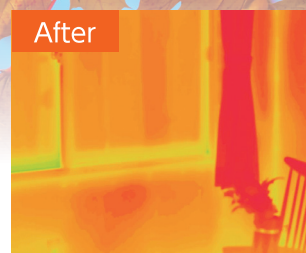
単板ガラス+内窓インプラス (Low-E複層ガラス)
