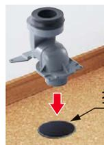
排水管接続部を前側にして排水管と接続。
