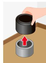
排水ゴムジョイントを取り外し、排水管を床面で切断する。
